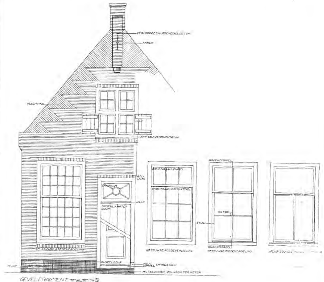
Een geveltekening van een niet bestaande gevel, een aantal raamtipes tonend en benoemend, benevens enkele andere details
